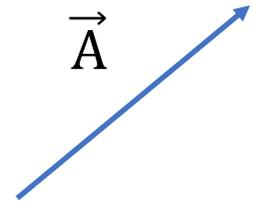
**Disegnare un vettore:** la freccia indica la **direzione** ed il **verso** del vettore, la sua lunghezza indica il modulo
