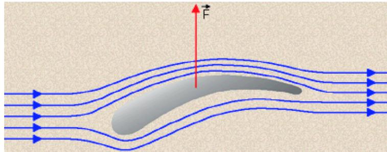
L'aderenza di un veicolo al suolo è garantita con la particolare sagomazione del fondo del veicolo in maniera tale che sia piatto e abbia dei diffusori sulla coda che permettono la rapida fuoriuscita del flusso di aria
